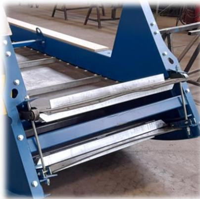
**Ad[A]** Die einzelnen Teile des Gurtes werden vor dem eigentlichen Einbau des Gurtes mit einem Kettenschloss, die zusammen mit dem Gurt geliefert wird, zu einem Ganzen verbunden.
