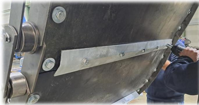
Die Montage des Gurtes beginnt im Bereich der Montageseitenwände (oberer Trum) oder im Bereich des Spannkopfes (unterer oder oberer Trum). Es kommt immer auf die räumlichen Möglichkeiten einer bestimmten Installation an.
