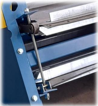
Zur Sicherung des Riemens gegen Bewegung während des Transports und der Manipulation werden Gewindestangen verwendet, die vor dem Verbinden des Gurtes entfernt werden müssen.
